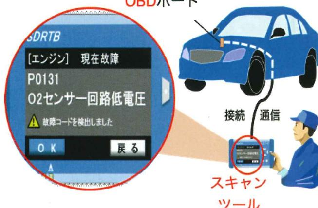
「スキャンツール」をOBDポートに接続し、「OBD」が記録している、各種装置の故障の有無や作動状況を読み出すことで、装置が正常に作動しているかを点検します（いわゆるOBD点検）。
